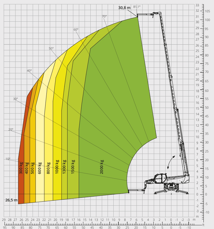
Load chart with JIB, 2,000 kg ATT - 04 - 013
