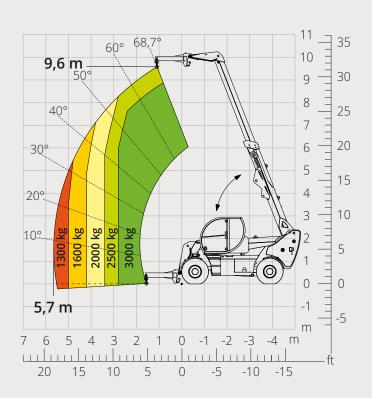
Esquema de capacidades de carga con **CESTA 450 kg PARA MINAS** ATT-01-027
