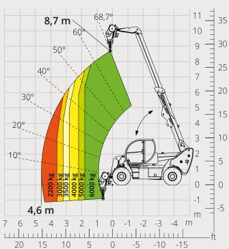
Esquema de capacidades de carga con PLUMÍN 3000 kg ATT-04-019
