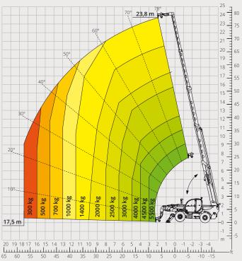
Esquema de capacidades de carga con **PLUMÍN 2000 kg** *ATT-04-013*
