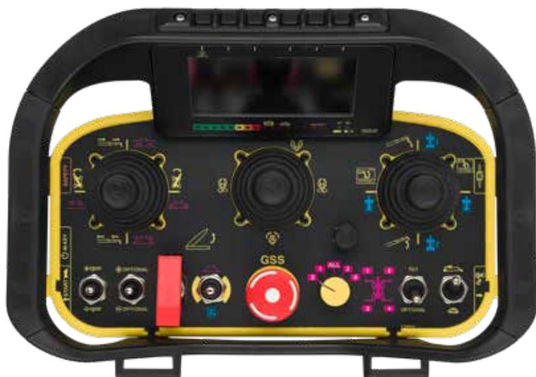
Mando de control dotado de una práctica pantalla a color en la que es posible ver todos los datos geométricos del brazo desde el suelo, para incrementar la seguridad del operador. Posibilidad de accionar el accesorio cortarramas directamente mediante un botón situado en el mando de control. El mando de control utiliza el sistema Bluetooth y por lo tanto puede ser usado en todo el mundo sin ninguna restricción particular.
