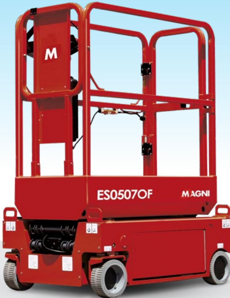
La nueva plataforma eléctrica Oil Free utiliza actuadores eléctricos para la elevación, el descenso y la dirección, lo que reduce las emisiones de ruido. Son adecuadas para contextos en los que es esencial evitar la contaminación por derrames de aceite o combustible.
