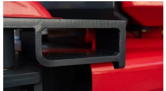
Orificios integrados para el transporte con horquillas
