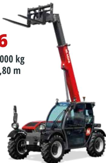
Deutz 55,4 kW (75,3 CV) a 2600 rpm
