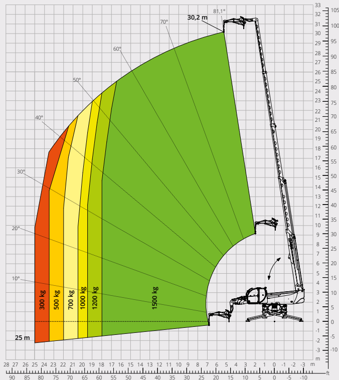
Abaque de charge avec POTENCE AVEC TREUIL 1 500 kg ATT - 04 - 011
