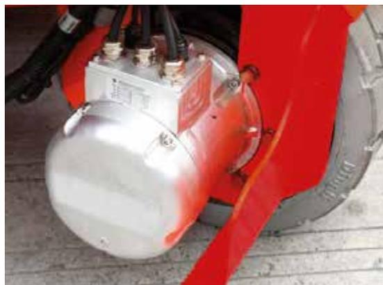
Protezione motore di trazione
