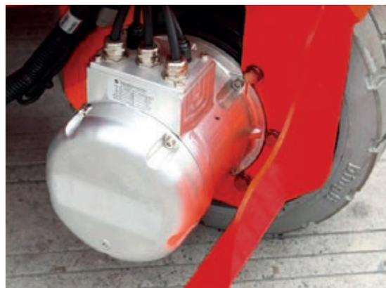
Protezione motore di trazione
