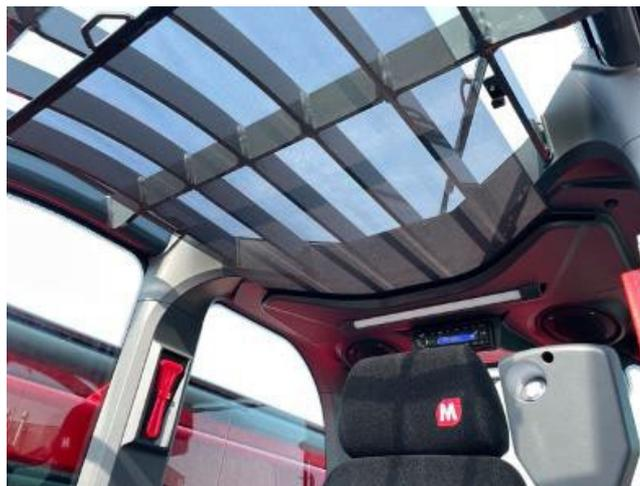
I flussi d'aria all'interno della cabina sono stati migliorati con un nuovo disegno nella parte bassa del parabrezza, in modo da ottimizzare lo sbrinamento anche in climi rigidi.
