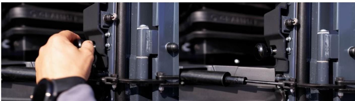
Il sistema "**easy access**", brevettato da Magni, consente durante la rotazione della torretta di arrivare in un punto in cui il braccio di sollevamento è in posizione di accesso, e posto
