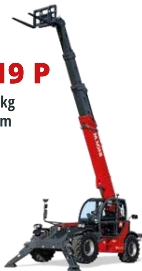
Deutz 74,4 kW (101,2 cv) a 2.200 giri/min
